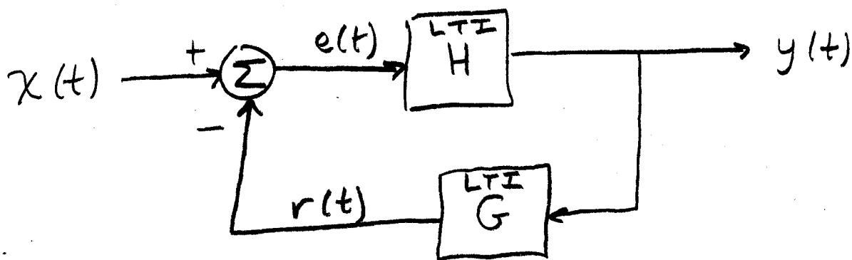
$$Q(\omega) = \frac{H(\omega)}{1 + H(\omega)G(\omega)}$$
